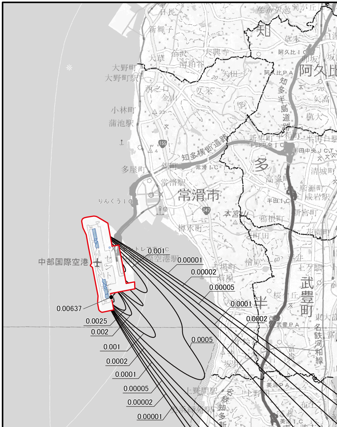
図10.2.1-12(1) 建設機械の稼働による浮遊粒子状物質 (寄与濃度:1時間値(昼間工事時))の予測結果 単位:mg/m 3
