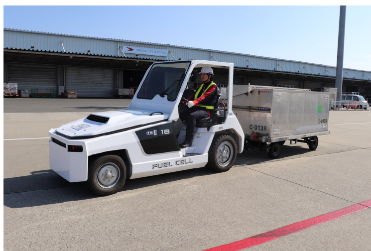
図 4.4-12 燃料電池トーイングトラクター貨物地区実証実験の様子
