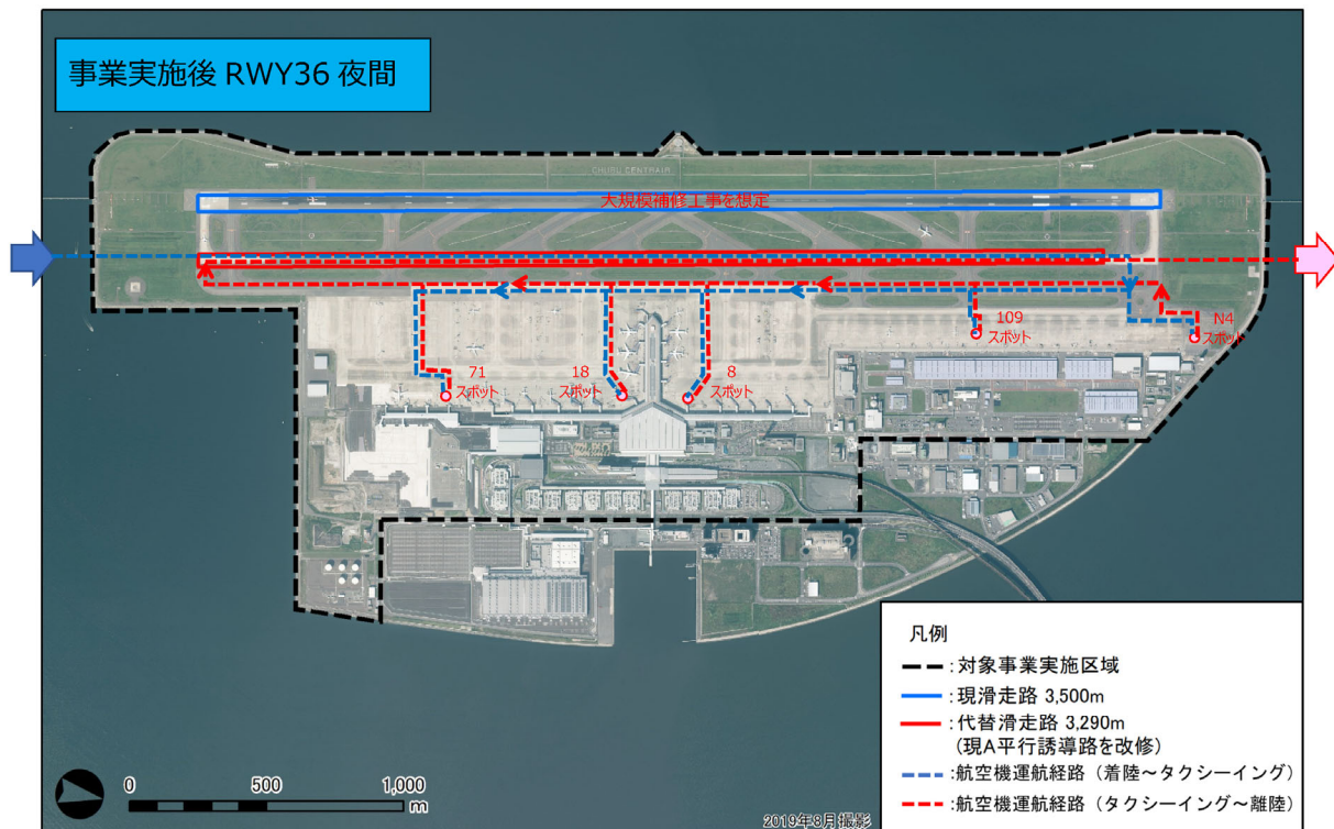
図 10.2.3-7 (4) タクシーイング経路・アイドリングスポット位置 (事業実施後・北向き運用)
