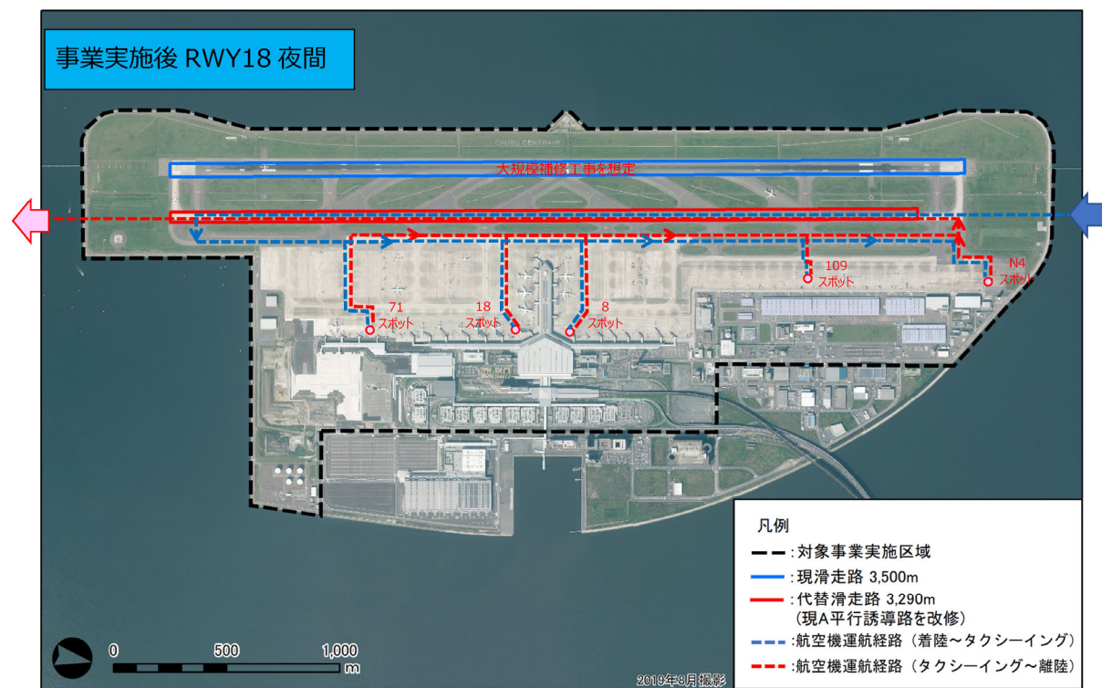
図 10.2.3-7 (3) タクシーイング経路・アイドリングスポット位置 (事業実施後・南向き運用)
